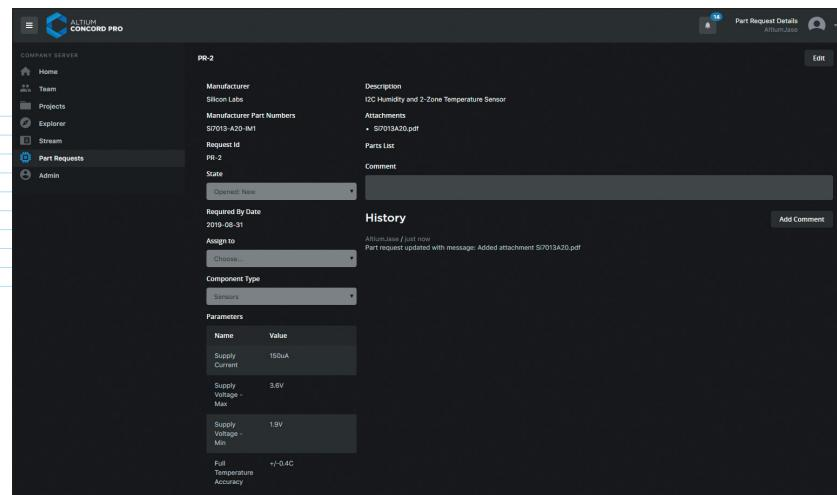
Рис. 7. Пример запроса компонента в веб-интерфейсе *Altium Concord Pro*
