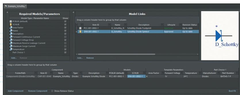
Рис. 2. Интерфейс редактора *Component Editor* в режиме *Batch Component Editing*
