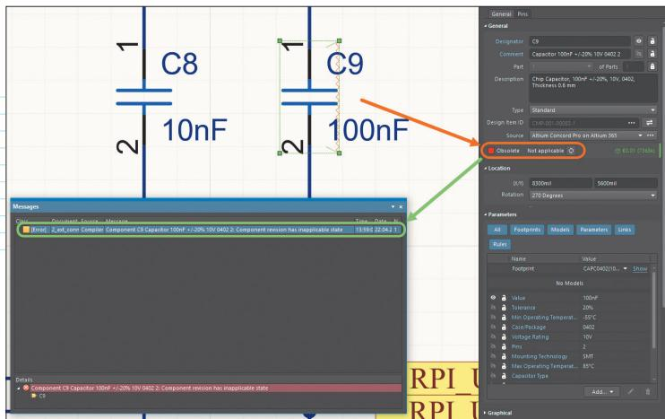
Рис. 4. Валидация проекта с компонентом в неприменимом состоянии
